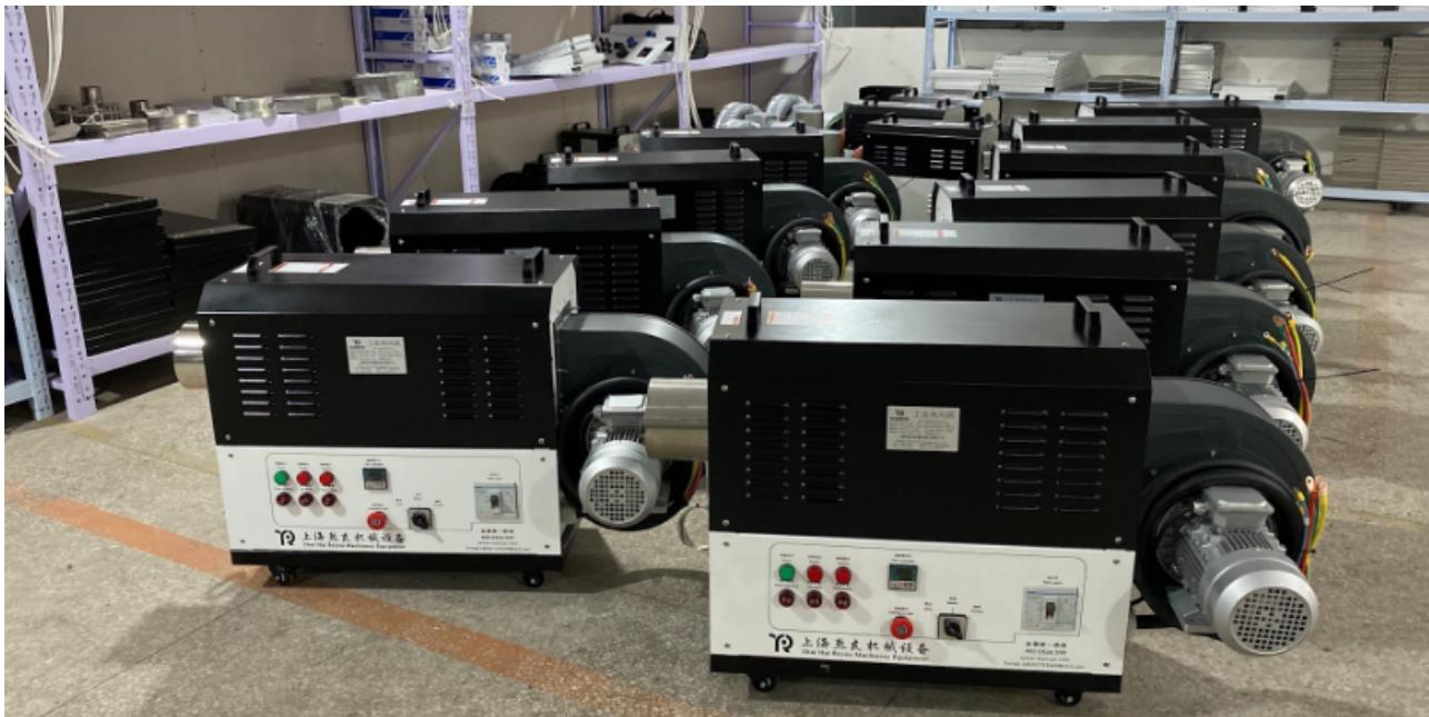
工业热风机的运用十分广，它的工作环境各不相同，专业工业热风机生产商建议用户在使用该设备之前，首先检查设备各零件是否处于正常状态，重要的加热元件是否出现磨损、老化或者失灵等问题。用户必须确保机器没有任何安全隐患的状态下，才可以启用该机器。如果用户在开机之前发现了机器的故障或异常现象，一定要停止使用机器，排除机器的安全故障后才能重新运行。质量再好的设备在长期的使用之后，也容易出现运行故障，因此，用户应该根据工业热风机的使用频率和时间，对该设备制定好有规律且合理的日常维护计划。用户应该认真执行日常维护计划，做好对应的清洁工作，这样才能保持设备稳定的使用状态，同时延长设备的使用寿命。
